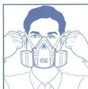
6. Pomocí zadních nastavovacích prvků utáhněte spodní pásky (napětí pásky lze snížit zatlačením na černé strany přezek).
