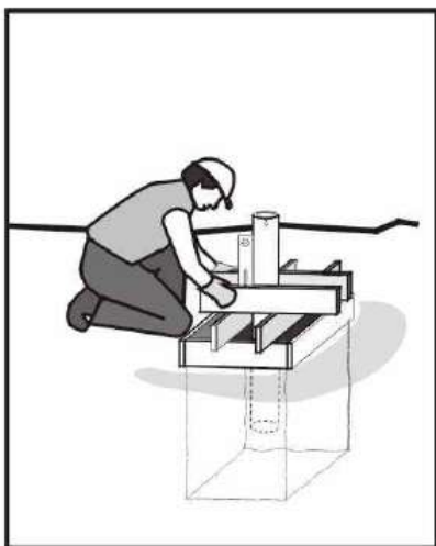
5. Před zavádnutím betonu provedeme přesné srovnání kolmosti patky
