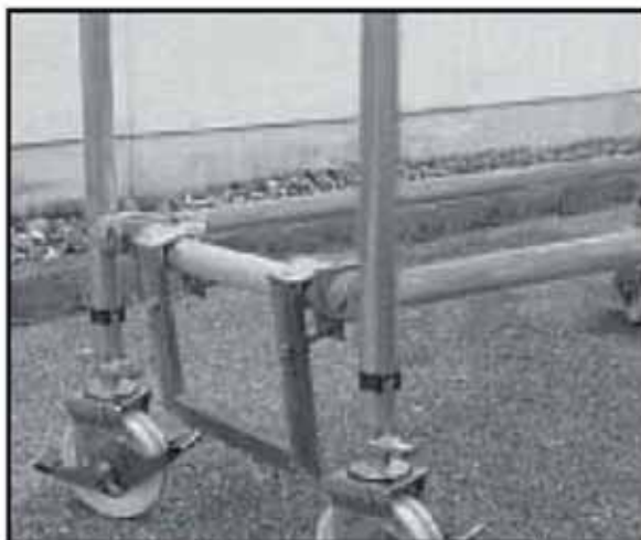
Obr. 18 Montážní nastavení nástupního třmene
